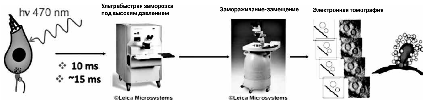
8 Кортиев орган стимулируется лазером, через 10–15 миллисекунд происходит витрификация образца в системе для заморозки под высоким давлением. Затем витрифицированная вода заменяется органическими растворителями и далее смоллой. После окраски, контрастирования и подготовки срезов толщиной 200 мкм образцы готовы к электронной томографии
